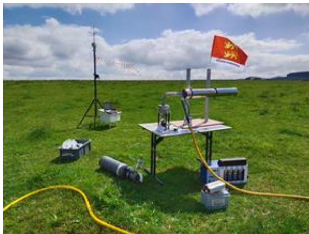
Figure 1. Point d'émission du panache composé de gaz traceur et de particules.
